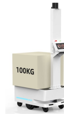
送料机器人 载重100KG、水平方向任意 行走、提供视觉辅助避障
